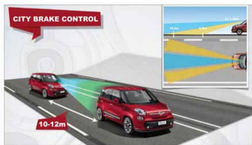
El sistema ‘City Brake Control’ está activo si la velocidad del vehículo está comprendida entre 5 y 30 km/h.
